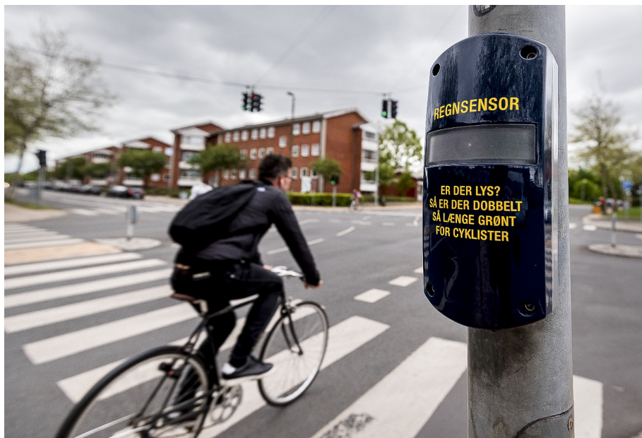
Figur 3. Regnsensoren er det unikke element, som giver cyklisterne på Supercykelstien dobbelt så lang grøntid, når det regner. Det er kun lavet i 1 kryds.
